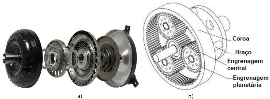
Figura 5: Caixa de velocidades automática a)- conversor de binário, b) engrenagens [18].
