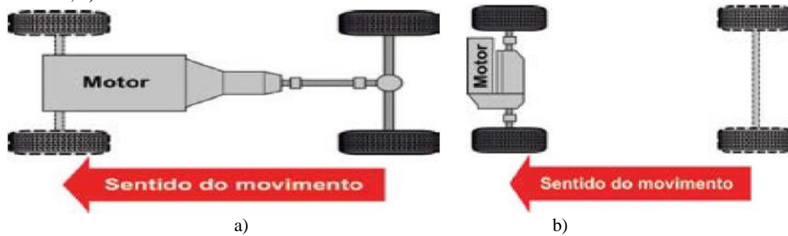
Figura 1: Tipos de transmissões (Padilha, 2018) [3]. a)- com motor e transmissão longitudinal em linha posicionado a frente do veículo, b)- com motor transversal a frente do veículo
