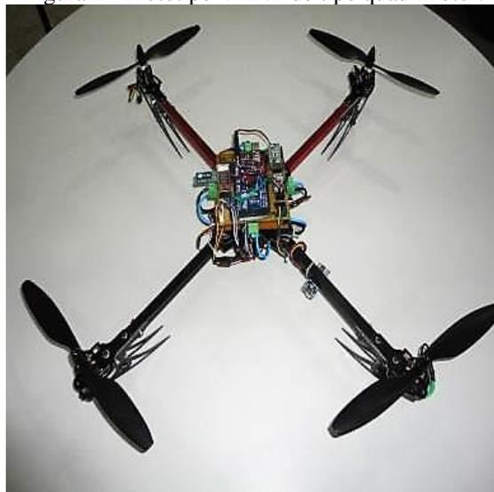
A elaboração do protótipo iniciou-se a partir da especificação dos materiais e dispositivos a serem embarcados no quadricóptero. Posteriormente, foram adquiridos os elementos sensores, de controle e atuadores, bem como a estrutura de suporte e bateria. Então, foi elaborado o projeto para confecção das placas de força e de controle utilizando-se de ambiente computacional CAD para posterior execução e montagem dos itens.
